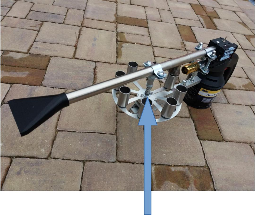
Einmal pro Saison einen Tropfen hoher Temperatur setzen beständiges Schmiermittel in die Mitte des Karussell zum Schmieren des Gleitlagers.
